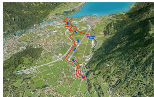
Figure 101 : Couloir d'écoulement en cas de surcharge (Lütschine à Bönigen). Source : HWS Bodeli WBP Lütschine, TP2 Überlastkorridor Wilderswil - Brienersee, Flussbau AG SAH und Mätzener & Wyss Bauingenieure AG 2015.
