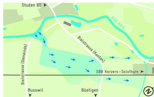
Figure 177 : Surface inondable avec fonction de décharge sur la rive droite du cours d'eau (ancien Aar à Dotzigen ; source : www.alte-aare.ch ).
