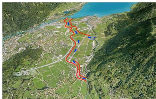
Figure 179 : Couloir d'écoulement en cas de surcharge (Lütschine à Bönigen). Source : HWS Bödeli WBP Lütschine, TP2 Überlastkorridor Wilderswil - Brienersee, Flussbau AG SAH und Mätzener & Wyss Bauingenieure AG 2015.
