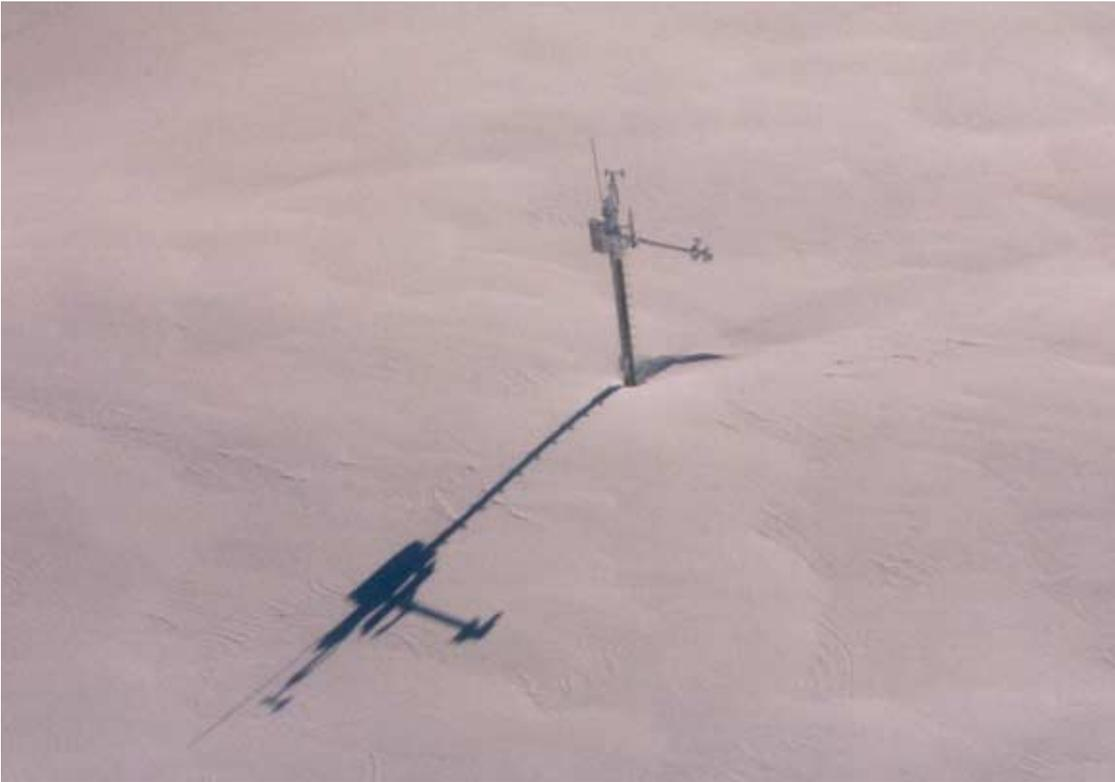
Grössere Probleme traten hingegen erwartungsgemäss bei den stark exponierten Windmessstationen auf den Gipfeln auf. Ein wesentliches Problem bestand in der Bildung von kompakten "Schnee/Eis-Mänteln" im Bereich der Sensoren. Dadurch wurde die Messung der Windrichtungen und Windstärken teilweise über längere Zeit verunmöglicht.
