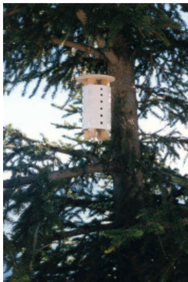
Abb 20, 21, 22 Anordnung der Temperaturlogger: Luft, Boden 3 und 30 cm
