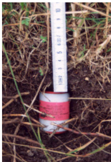
Abb 20, 21, 22 Anordnung der Temperaturlogger: Luft, Boden 3 und 30 cm
